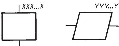
4.1.7 В схемах работы системы символы, отображающие носители данных, во многих случаях представляют способы ввода-вывода. Для использования в качестве ссылки на документацию текст на схеме для символов, отображающих способы вывода, должен размещаться справа над символом, а текст для символов, отображающих способы ввода, — справа под символом.
