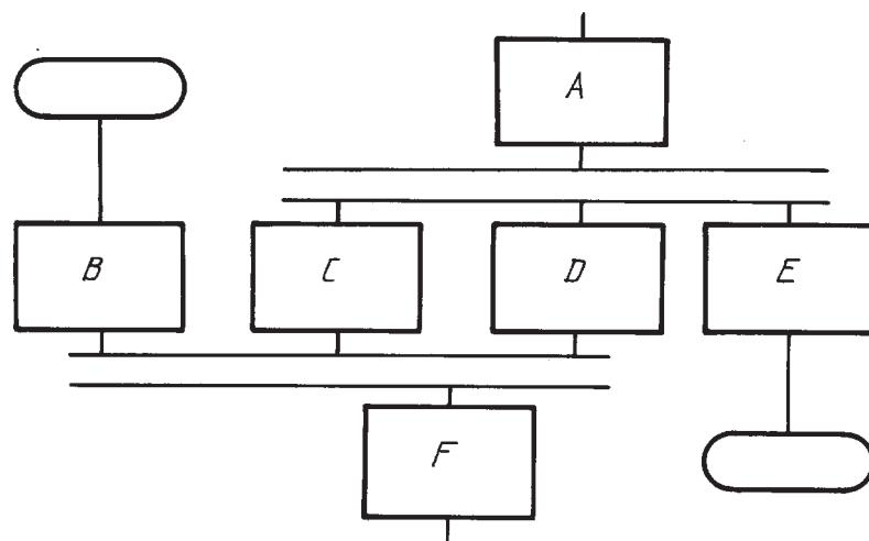
**П р и м е ч а н и е.** Процессы С, D и E не могут начаться до тех пор, пока не завершится процесс A; аналогично процесс F должен ожидать завершения процессов B, C и D, однако процесс С может начаться и (или) завершиться прежде, чем соответственно начнется и (или) завершится процесс D.
