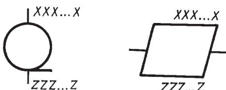
4.1.8 В схемах может использоваться подробное представление, которое обозначается с помощью символа с полосой для процесса или данных. Символ с полосой указывает, что в этом же комплекте документации в другом месте имеется более подробное представление.
