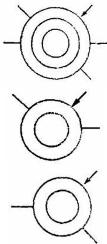
Примечание. Все угловые размеры в обозначениях (углы между линиями отводов, между подвижными механически связанными контактами, размеры и расположение секторов изолированных или короткозамкнутых участков) должны быть приблизительно равны соответствующим угловым размерам в конструкции потенциометров.
