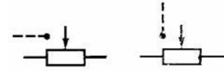
2. При разнесенном способе замыкающий контакт следует изображать
