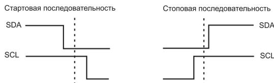
Протокол I<sup>2</sup>C требует, чтобы сигнал на линии данных SDA оставался неизменным при высоком уровне сигнала SCL. Перепад сигнала на линии SDA из высокого в низкий уровень при высоком уровне сигнала на линии SCL инициируется ведущим и указывает на начало обмена данными. Если при высоком уровне сигнала на линии SCL сигнал на линии SDA переходит из низкого в высокий уровень, то эта последовательность сигналов интерпретируется как завершение операции обмена данными на шине.
